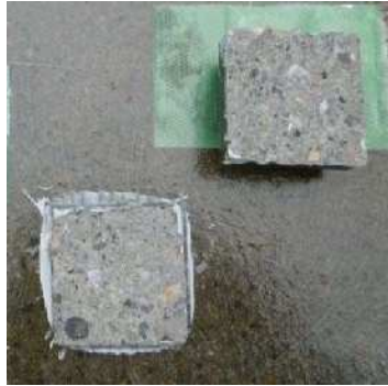
破断面にレイタンスなし
