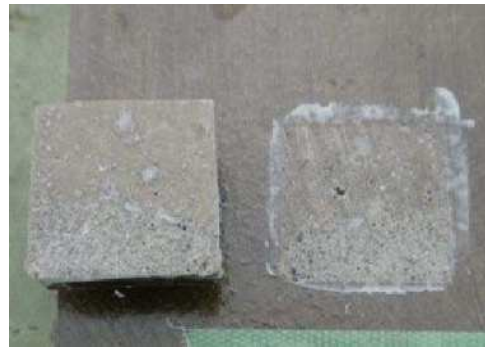
破断面にレイタンス
